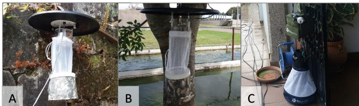
Figura 10. Trampa CDC de luz ultravioleta (A), trampa CDC de luz branca (B) e trampa BG-PRO (C).
